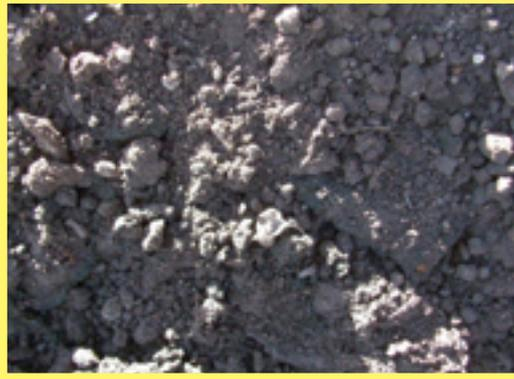
Abbildung 80: Eisenzunder mit 2,2 % Mineralölgehalt – gefährlicher Abfall – AA010
