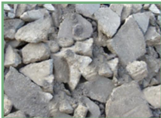
Abbildung 45: Betonabbruch
