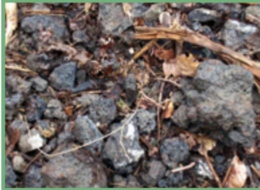
Abbildung 64: Elektroofenschlacke (chromhaltig) aus einem Edelstahlwerk – Grüne Liste bei zulässiger Anwendung – Nota bene: Aufschüttung auf Böden/Wegen ist illegal!
