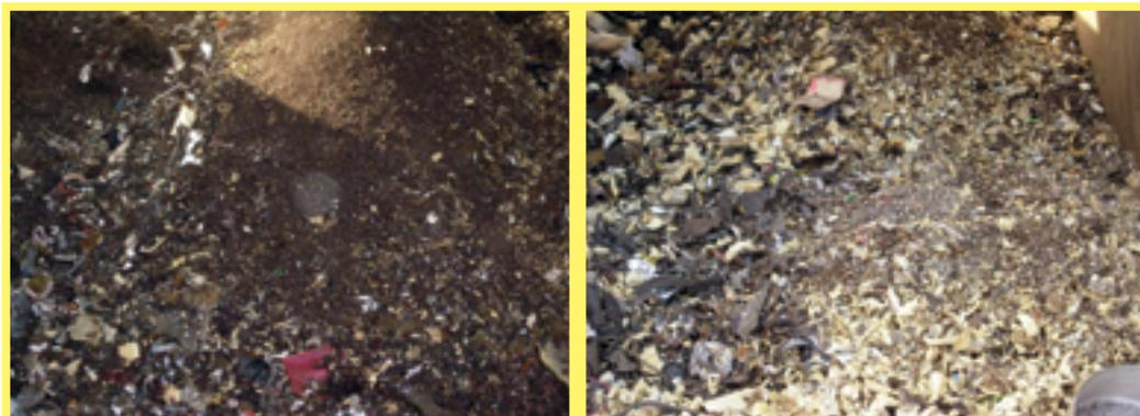
Abbildung 207: Shredderleichtfraktion – A3120
