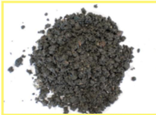
Abbildung 58: Schlacke aus der Verbrennung gefährlicher Abfälle – nicht gelisteter Abfall
