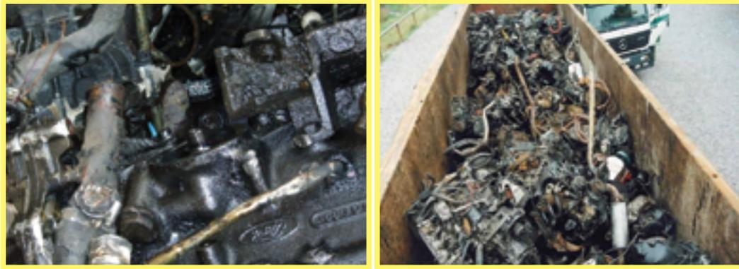
Abbildung 85: Nicht restentleerte Fahrzeugmotoren, kein Funktionsnachweis – A1180
