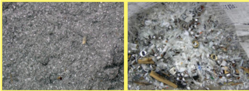
Abbildung 31: Aluminiumfeinspäne (20 % der Fraktion unter 100  $\mu\text{m}$ ) – nicht gelisteter Abfall
