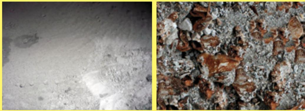
Abbildung 74: Filterstaub aus Edelstahlgießerei – A4100
