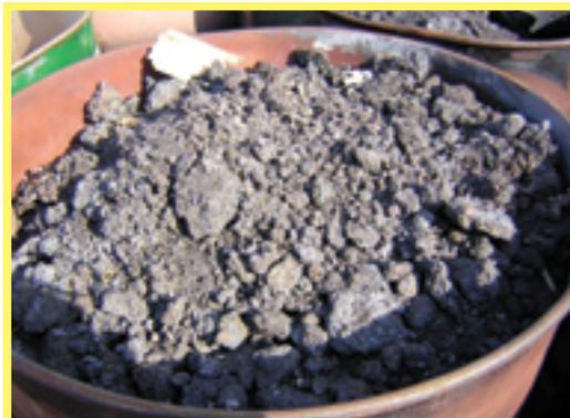
Abbildung 187: Kupferraffinationsmaterial mit mehr als 0,3 % Bleiverbindungen (reproduktionstoxisch) - HP10-Kriterium gemäß EG-Rechtslage – nicht gelisteter Abfall oder A1020
