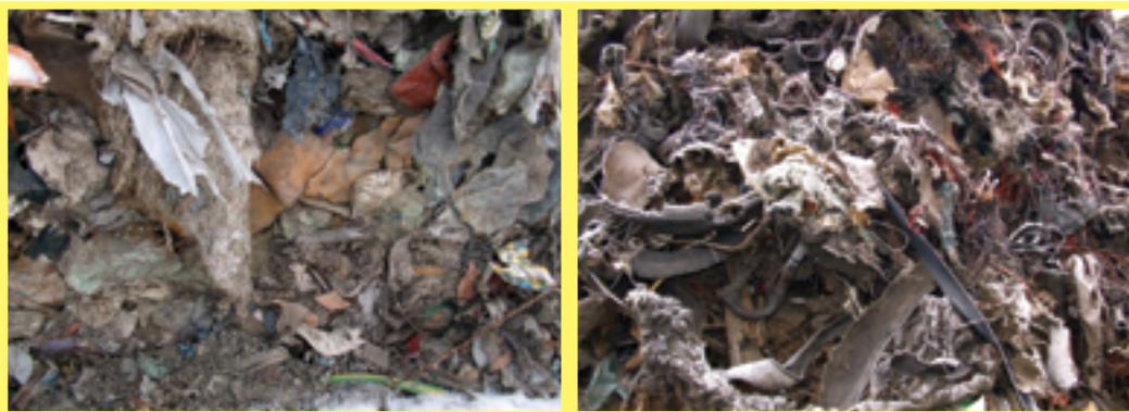
Abbildung 211: Shredderleichtfraktion – A3120
