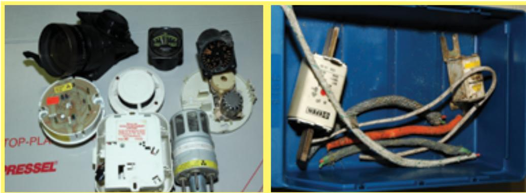
Abbildung 107: Radioaktive Bauteile (ggf. treffen Strahlenschutzbestimmungen zu) – A1180
