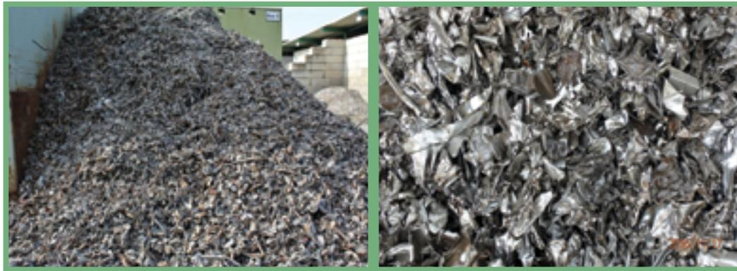
Abbildung 70: Nirosta-VA Edelstahlabfälle > 90 % Metallanteil
