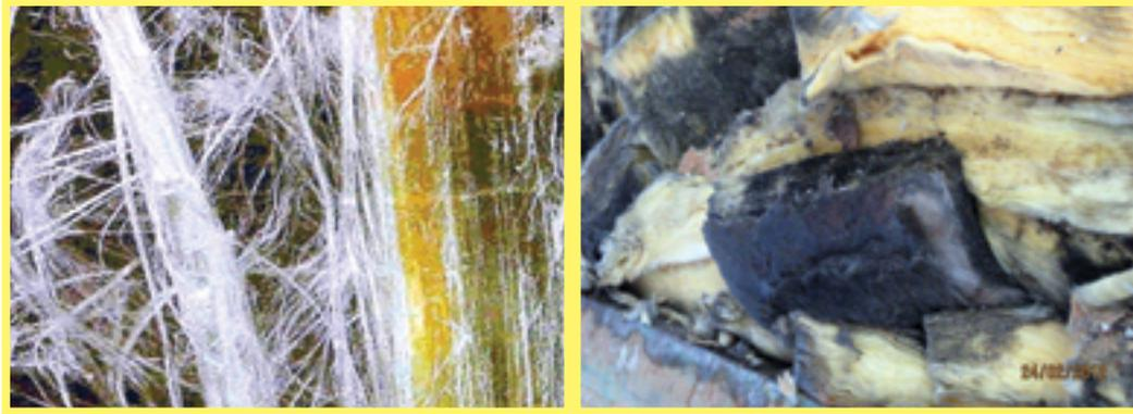
Abbildung 133: Asbestfasern – A2050
