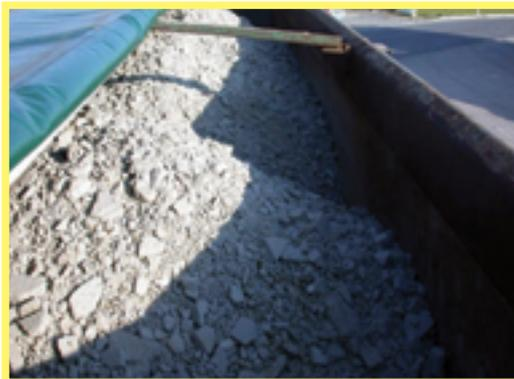
Abbildung 240: Zinkhydroxid bzw. Jarositschlamm (getrocknet) – A1070
