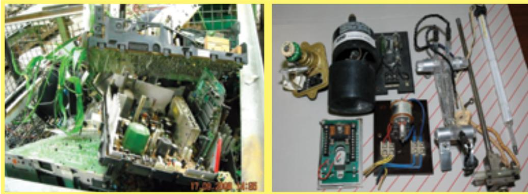
Abbildung 105: Mit gefährlichen Bauteilen bestückte Platinen – A1180
