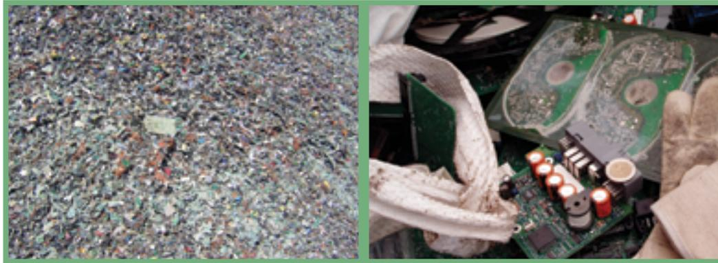
Abbildung 89: Geshredderte Leiterplatten, die vorher von gefährlichen Bauteilen befreit wurden
