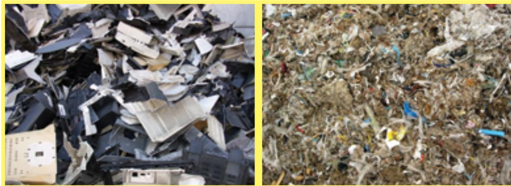
Abbildung 176: Kunststoffe von Monitorrückwänden mit weit mehr als 0,2 % Bromgehalt, wobei die POP-Grenzwerte überschritten wurden – nicht gelisteter Abfall
