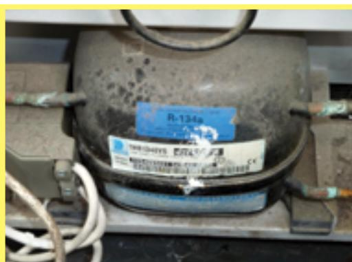
Abbildung 84: Alter Kühlschrankkompressor mit Kältemittel R134a – A1180
