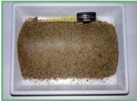
Abbildung 65: Schlackensand (granulierte Eisenschlacke) – PRODUKT
