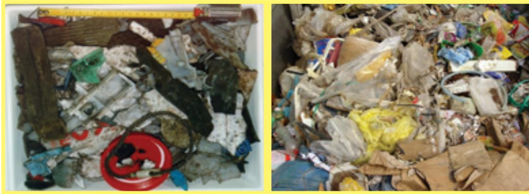
Abbildung 174: Kontaminierte Polypropylen-Akkumulatorenabfälle – A1020 oder A1160
