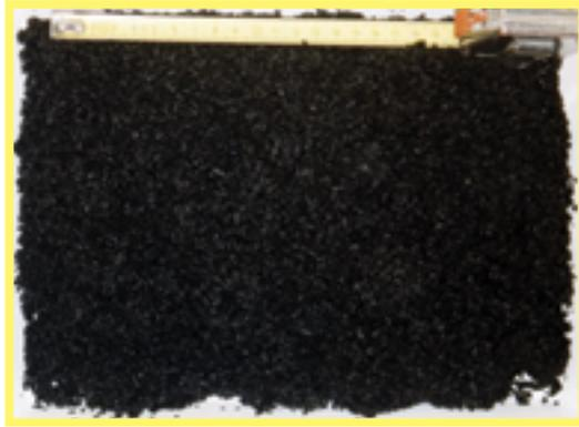
Abbildung 16: Kontaminierte Aktivkohle aus der Wasserreinigung – A4160
