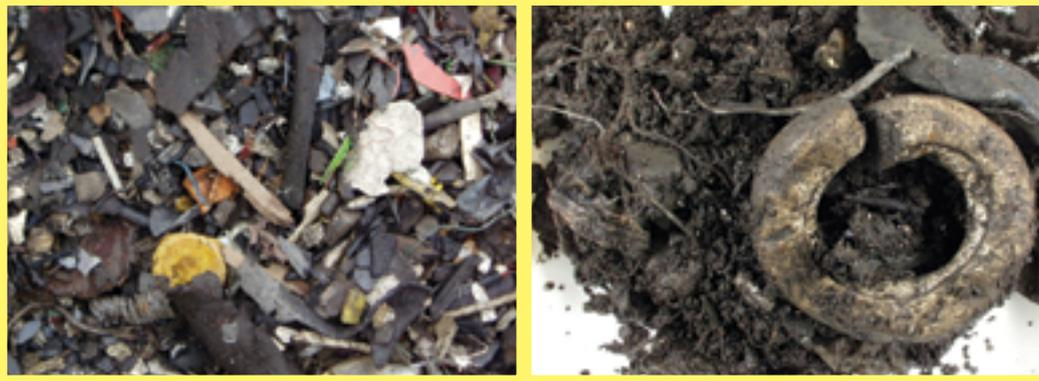
Abbildung 209: Shredderleichtfraktion – A3120
