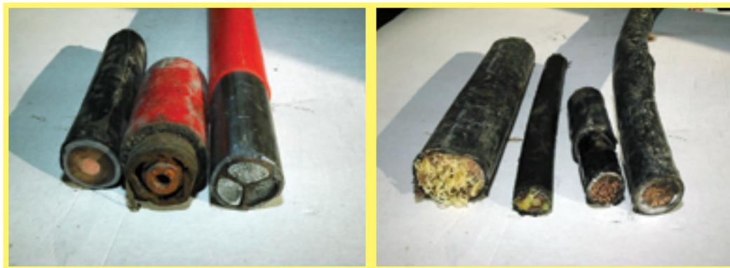
Abbildung 253: Erdkabel (Ölisolierung)
