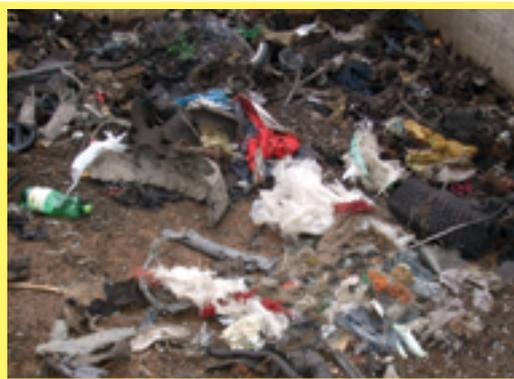
Abbildung 136: Thermische Fraktion (stark verunreinigte Kunststoff-Gummifraktion) – nicht gelisteter Abfall
