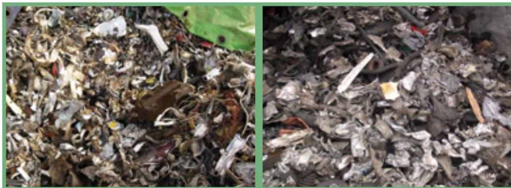
Abbildung 205: Nichteisenmetallshredderschrott
