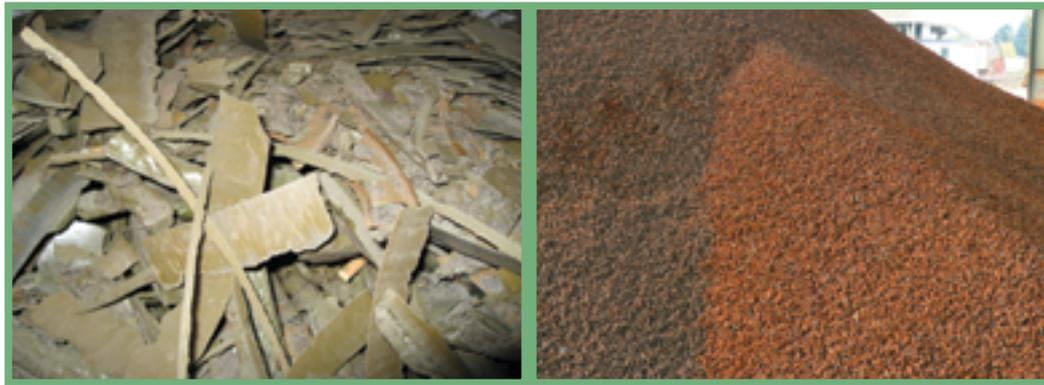
Abbildung 161: Keramikabfall aus der Herstellung von Keramikschleifscheiben
