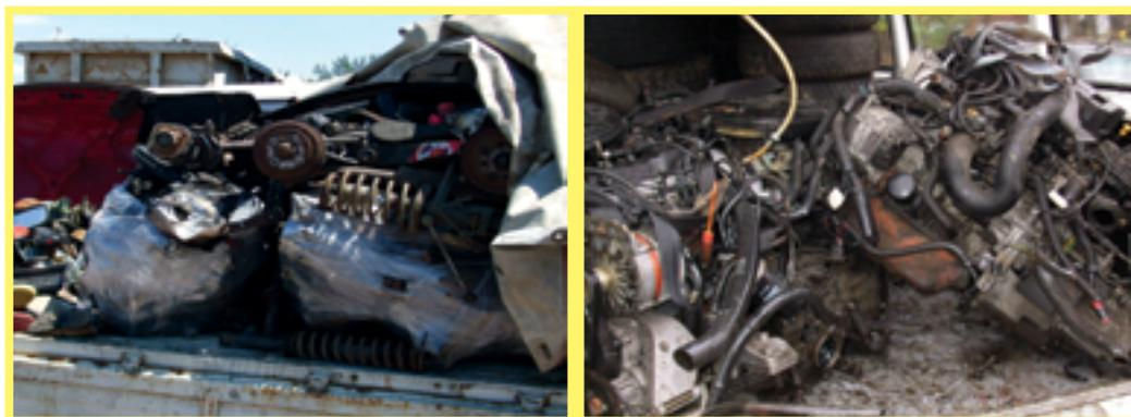
Abbildung 8: Motoren und Achsen in loser Schüttung – gefährlicher Abfall
